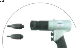
Outil haut de gamme. Parfaitement adapté aux fortes cadences. Préhension automatique de l'insert. Réglage de course et de traction. Piston de traction hydropneumatique. Dégagement par rotation inverse automatique de la tige après écrasement de l'insert. Corps composite, poignée confort, raccord tournant, soupape de sécurité. Livré en mallette comportant clés de réglage, burette de remplissage, nez et tiges de M3 à M12, manuel en français.
