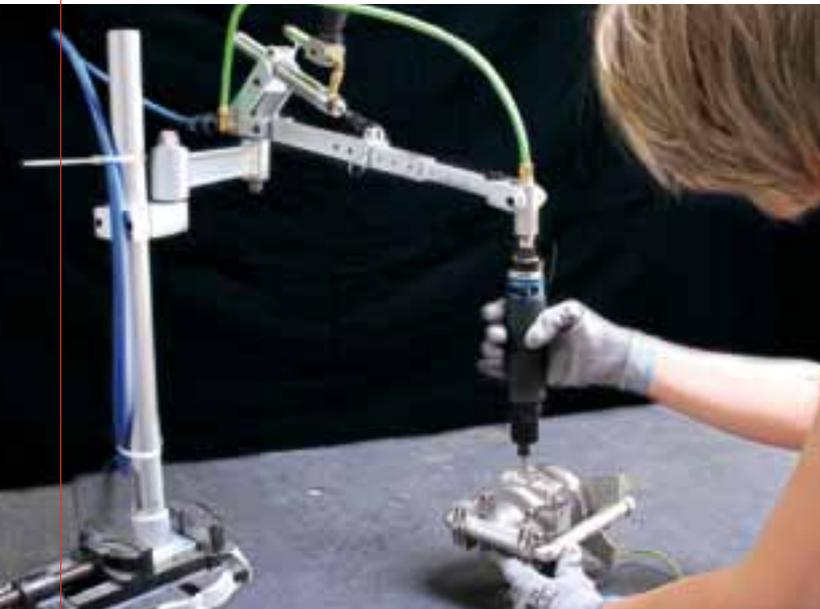
Embrayage "à limiteur de couple à billes" (ou "à friction" ou "à crabot") : précision rudimentaire. Limite considérablement le couple de réaction dans le poignet de l'opérateur. Utilisation en tôlerie ou menuiserie aluminium pour le montage de vis auto-perceuses dans l'acier, l'aluminium, ou PVC. C'est le type d'embrayage que l'on trouve communément sur les outils électroportatifs grand-publics.
