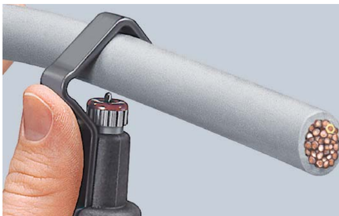
Positionnement de l'outil pour coupe périphérique
