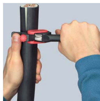
Tourner l'outil pour réaliser une coupe circulaire
