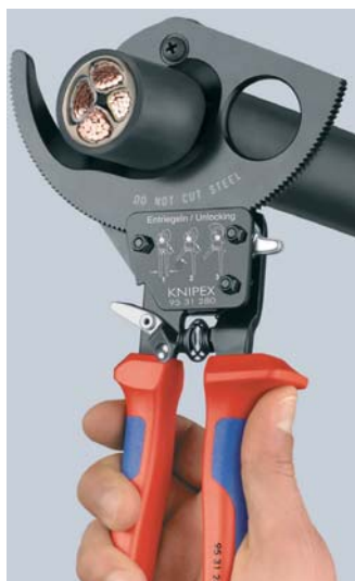
Principe du cliquet et entraînement par couronne dentée à 2 positions pour une coupe moins fatigante
