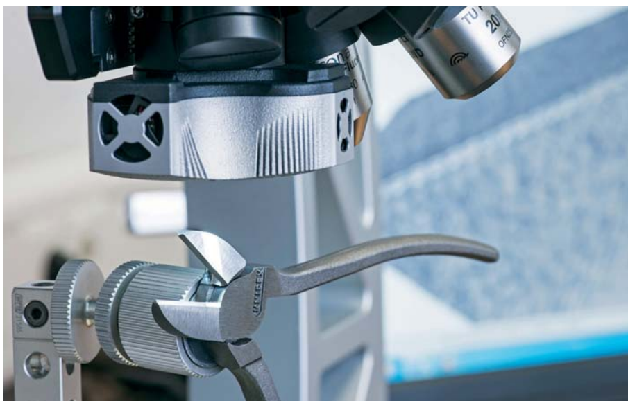
Contrôle optique 3D de la rugosité des tranchants.
