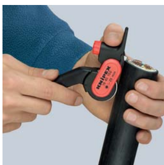
Positionnement de l'outil pour coupe longitudinale
