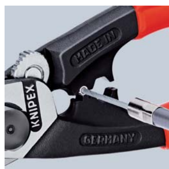
Sertissage de l'embout sur le câble tracteur
