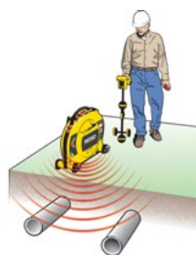
Induisez un signal pour localiser des impétrants.
