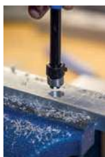
Étape 3 : montage de l'insert fileté
